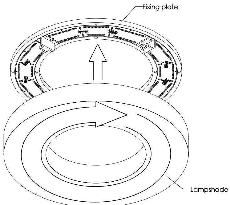
MONTAGE DIM TO WARM: Montieren Sie den Lichtschirm auf die Platte mit den gelieferten Schrauben siehe beigefügten Plan. Beachten Sie die LEDs nicht zu verletzen.
